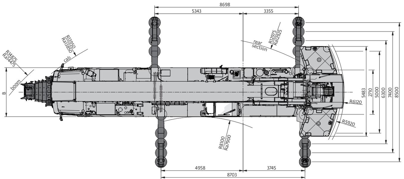
*Ra = Radius all wheels steered. • Radius allradgelenkt. • Rayon toutes les roues directrices. • Radio de giro con todas las ruedas giradas. • Raggio di curva con tutte le ruote sterzate. • Радіус поворота при управленні всіма колесами.*
