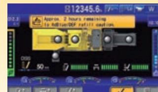
Indicator pentru nivelul AdBlue® si indicatii de reumplere
