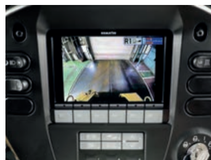
Sistem complet integrat pentru camera video retrovizoare
