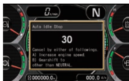
Functionare la ralanti a motorului cu oprire programabila
