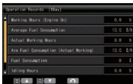
Un monitor multifunctional afiseaza si controleaza o multitudine de informatii operationale si de intretinere
