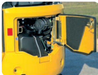
Usa capotaj spate: verificare rapida a motorului si realimentare combustibil
