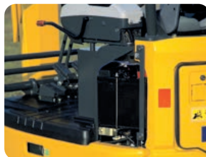
Usa capotaj dreapta: inspectie si curatarea radiatorului
