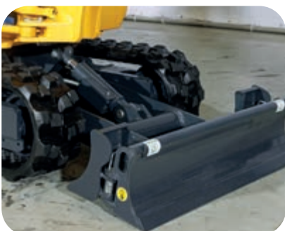
Lama pliabila pentru a se potrivi cu un sasiu cu latime variabila
