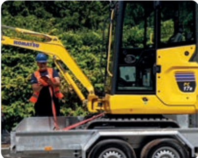
Punctele de fixare de pe structura superioara ajuta la asigurarea rapida a masinii pentru transport
