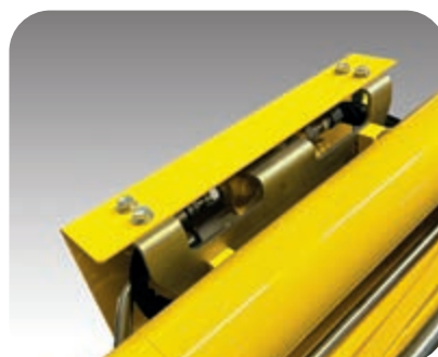
Supape de suprapresiune pe cilindrii brat si balansier
