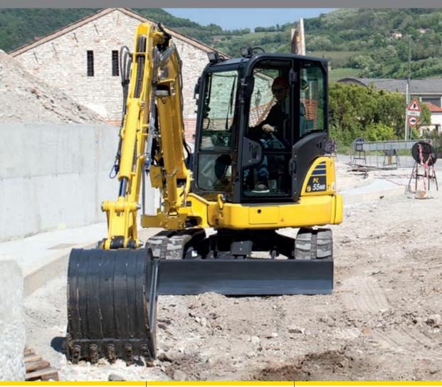
ENGINE POWER 29,1 kW / 39,0 HP @ 2.400 rpm **OPERATING WEIGHT** PC45MR-5: 4.950 kg PC55MR-5: 5.280 kg **BUCKET CAPACITY** PC45MR-5: 0,055 - 0,16 m<sup>3</sup> PC55MR-5: 0,055 - 0,18 m<sup>3</sup>
