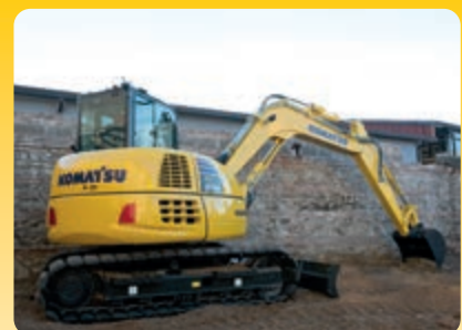
Raza frontala de rotire redusa si functia de rotire a bratului garanteaza saparea de santuri fara probleme
