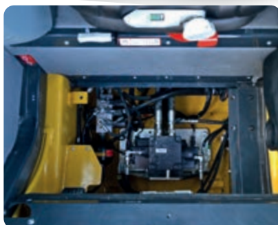
Datorita capotei interne a cabinei, intretinerea suplimentara a supapei principale poate fi efectuata rapid fara a inclina cabina.
