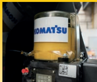
Sistemul de gresare automata montat din fabrica reduce activitatea zilnica de service la minimum (optiune)
