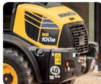
Transmisie hidrostatica cu viteza limitata la 40 km/h (optional)
