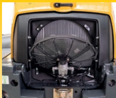
Ventilatorul radiatorului este rabatabil pentru un acces convenabil la curatare
