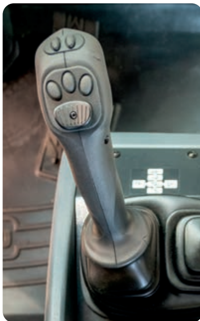
Maneta multifunctionala PPC cu control electronic optional pentru a 3-a si a 4-a functie de lucru (EPC)
