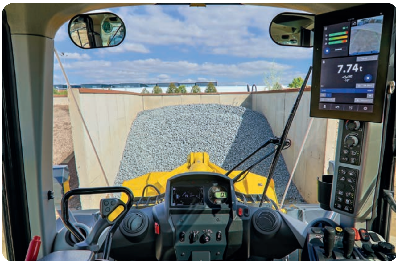
Imaginea prezinta sistemul avansat de directie cu joystick (AJSS) (echipament optional) si SubMonitor (echipament optional)
