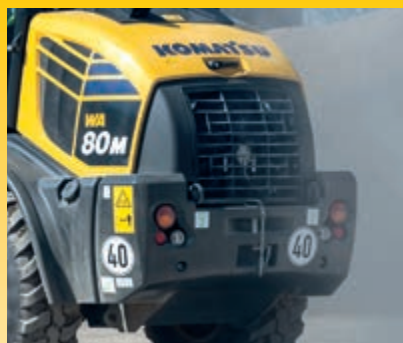
Radiator cu celule de racire largi si ventilator cu inversare automata a sensului inainte-inapoi (optional)
