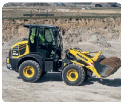
Sistem de amortizare a balansului cupei in mars, controlat electronic (ECSS) (optional)
