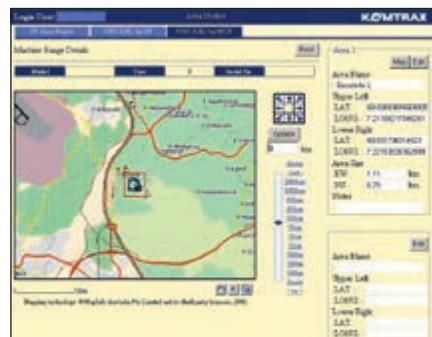
*Securitate totala – caracteristica "bloare motor" permite programarea momentului la care motorul utilajului sa fie pornit. De asemenea, cu ajutorul caracteristicii "arie geografica", Komtrax trimite notificari ori de cate ori echipamentul dumneavoastră se deplasează în cadrul sau în afara zonei de prestatiblile de dumneavoastră.*
