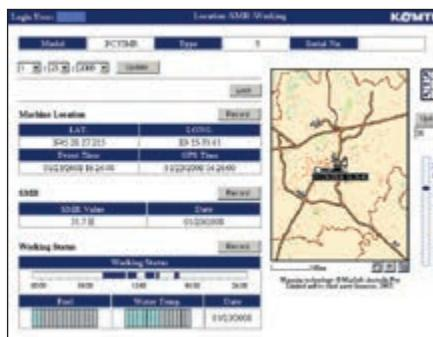
*Timpul de lucru al echipamentului – Cu graficul "Raport zilnic de lucru", primiti informatii exacte despre timpul de functionare a motorului: cand motorul a fost pornit si cand a fost oprit precum si timpul total de functionare a motorului.*
