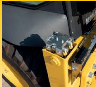
Supape de siguranta pentru stabilizatoare, brat si balansier (Standard)
