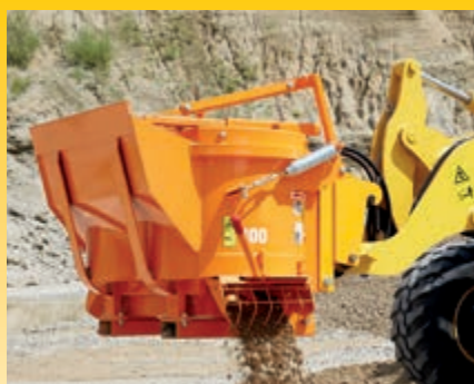
Versiunea High flow (debit ridicat) cu max. 120 l/min la 210 bar (optional)
