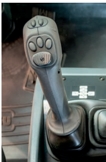
Maneta multifunctionala PPC cu control electronic optional pentru a 3-a si a 4-a functie de lucru (EPC)
