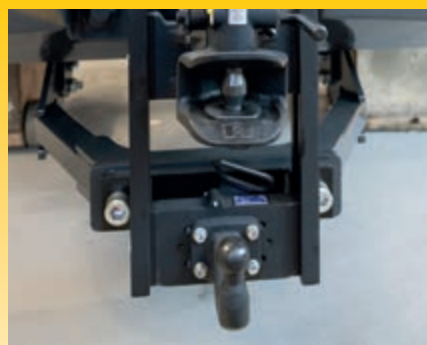
Cuple de remorcare cu inaltime reglabila, tip bila si automate (optional)
