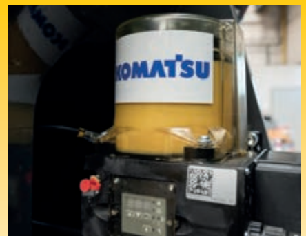
Sistemul de gresare automata montat din fabrica reduce activitatea zilnica de service la minimum (optiune)
