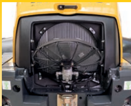
Ventilatorul radiatorului este rabatabil pentru un acces convenabil la curatare
