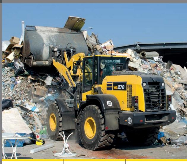
ENGINE POWER 115 kW / 153 HP @ 2.000 rpm **OPERATING WEIGHT** 12.975 - 13.525 kg **BUCKET CAPACITY** 2,2 - 2,3 m<sup>3</sup>
