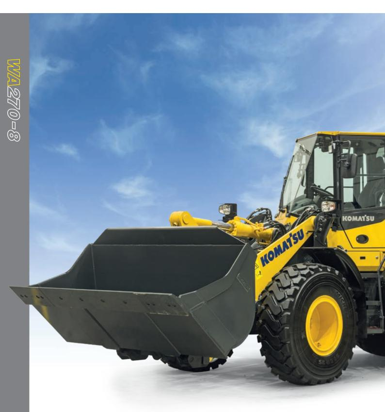
ENGINE POWER 115 kW / 153 HP @ 2.000 rpm **OPERATING WEIGHT** 12.975 - 13.525 kg **BUCKET CAPACITY** 2,2 - 2,3 m<sup>3</sup>
