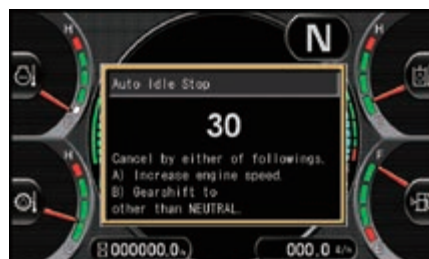
Sistem automat de oprire a motorului dupa un interval programabil de timp cu functionare la ralanti
