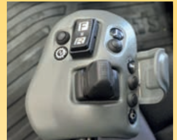
Sistem Komatsu de virare cu joystick (K-SLS) (optiune)
