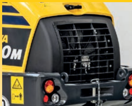
Radiator cu celule de racire largi si ventilator cu inversare automata a sensului inainte-inapoi (optional)
