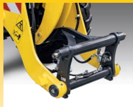
Cupla rapida activata electric pentru schimbarea rapida si usoara a atasamentelor de lucru
