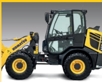
Inaltime totala scazuta (2,48 m) pentru transportare usoara
