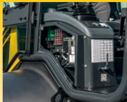
Capac lateral de acces rapid pentru intretinere
